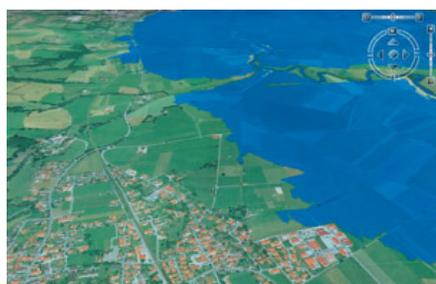
Im Geländemodell können die virtuellen Überschwemmungsflächen eines Flusses am Computer ermittelt werden.
